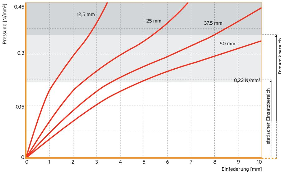
Abb. 1: Quasistatische Federkennlinie mit einer Belastungsgeschwindigkeit von 0,022 N/mm²/s
