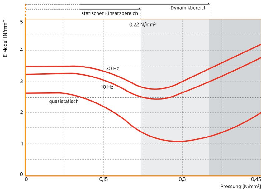
Abb. 2: Belastungsabhängigkeit der statischen und dynamischen E-Moduli
